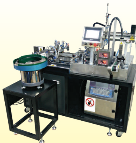
Automatisierte Prüfung der Löttestigkeit in der Produktion bei Umgebungstemperatur
