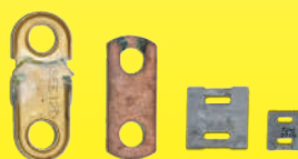
Kupfer, Messing und beschichtete Schmelzloten nach 300 Stunden Salzsprühnebel mit 20%
