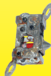
Feuerdetektions-Mechanismus aus verzinktem Stahl nach 240 Stunden Salzsprühnebel mit 20%
