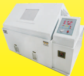
Testgeräte für Salzsprühnebel in unserem Labor
